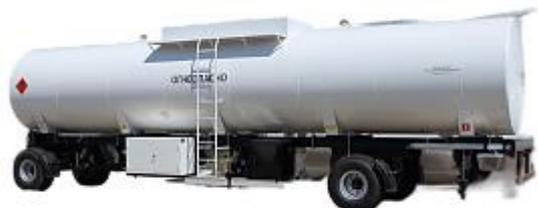
Прицеп-топливозаправщик предназначен для хранения и выдачи потребителям светлых нефтепродуктов, с возможностью транспортировки в опорожненном состоянии. Скорость передвижения не более 35 км/ч. Топливораздаточная колонка устанавливается с учетом требования заказчика
