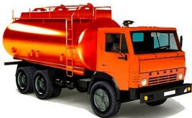
Benza Передвижная АЗС состоит из двустенного трехкамерного резервуара с горловинами, предназначенными для наполнения и осмотра внутренней поверхности корпуса резервуара, подрамника и технологического отсека обслуживания, расположенного в задней торцевой части резервуара Benza ПАЗС.
