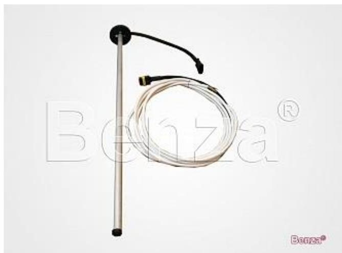
Датчик уровня топлива «Benzar FS» допускает обрезку под требуемую высоту бака. Степень обрезки датчика до остаточной длины -100 мм, после обрезки требуется дополнительная калибровка.
