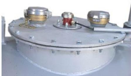
**Обвязка горловины ёмкости** предназначена для подключения ТРК по НБП 111-98(2002).
