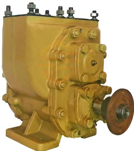
Насосы самовсасывающие типа СВН предназначены для перекачки светлых и темных нефтепродуктов: бензина, керосина, дизельного топлива, масел и других без механических примесей, кинематической вязкостью не более  $20 \cdot 10^{-4}$  м<sup>2</sup>/с и температурой от -40 °С до +70 °С, максимальная производительность 60 м<sup>3</sup>/ч.
