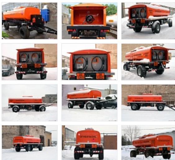
Прицеп-топливозаправщик предназначен для кратковременной транспортировки, хранения и выдачи потребителям светлых нефтепродуктов. Скорость передвижения не более 35 км/ч. Топливораздаточная колонка устанавливается с учетом требования заказчика (Benza, Ливенка-модуль или другие).
